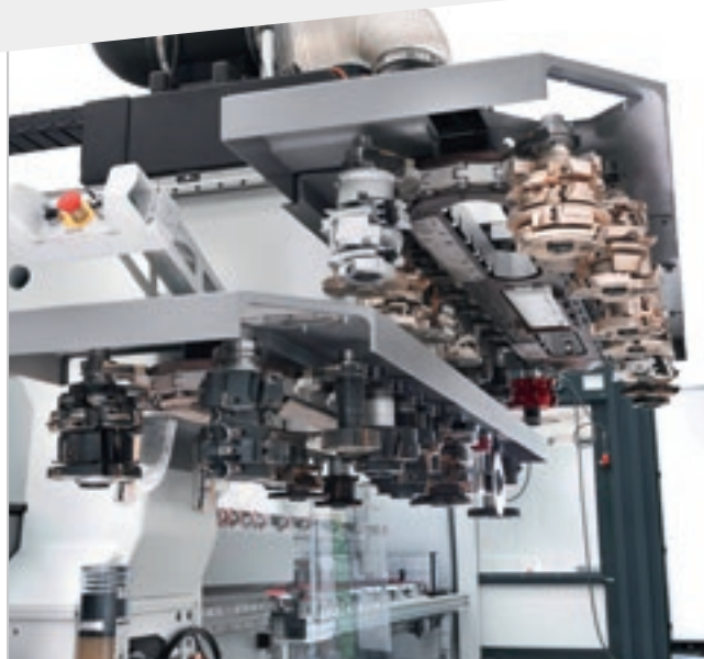
Magazzino a catena a doppio livello con 44 posizioni totali.
